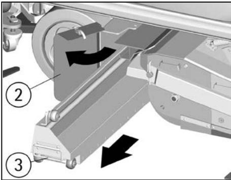
8. Vider le bac dans un récipient approprié à l'écoulement des déchets conformément aux normes en vigueur.
