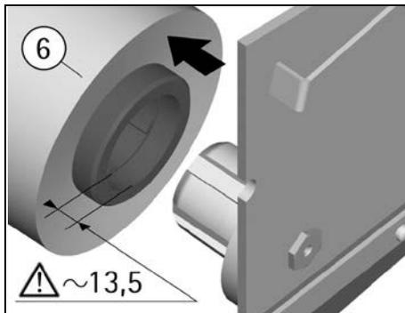
11. Repositionner ensuite les plaques du support (3) et (4), depuis l'attaque de blocage, revisser le pommeau et réinsérer l'arrêt (2) et enfin repositionner et bloquer la barre de la bavette latérale par l'arrêt (1).
