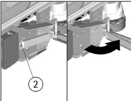
7. Extraire les plaques du support (3) et (4) des brosses en les tirant vers l'extérieur en utilisant les poignées appropriées.
