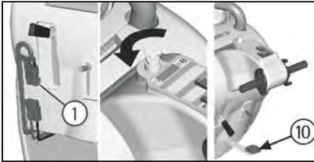
3. Mit angehobenem Bürstengehäuse, die zwei Flügelschrauben (1) losschrauben und danach die Seitenhalterung der Bürsten (2) entfernen.
