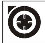
Symbole du moteur d'aspiration. On l'utilise pour indiquer l'interrupteur du moteur d'aspiration.
