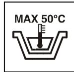
Indication de la température maximale du détergent de la solution. Elle est située près du trou de remplissage du réservoir de la solution.
