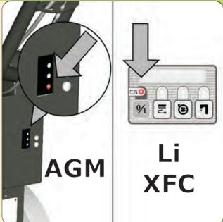
XFC: avec le témoin vert clignotant, les batteries doivent être rechargées (avec le témoin rouge, la machine s'arrête).
