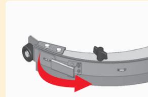
2) Desenganchar el cierre del listón fijador del labio.
