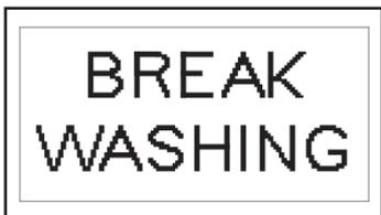
En este modo se cierra la electroválvula, después de unos segundos se eleva la bancada de cepillos y, por tanto, también la boquilla de secado, y se desconecta la aspiradora.
