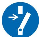
Este símbolo indica que, antes de cualquier operación en la máquina, el sistema debe ser desconectado de las baterías actuando sobre el conector.
