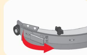
2) Desenganchar el cierre del listón fijador del labio.
