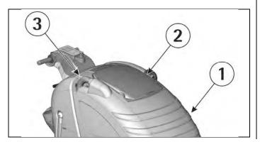
Grazie ad un sistema di bloccaggio a 2 livelli, la macchina permette la ricarica delle batterie con una parziale apertura del serbatoio.
