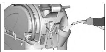
Sempre sul lato destro della macchina è posto il tubo livello, che permette di vedere facilmente la quantità di soluzione presente nel serbatoio, sia in fase di carica della soluzione che in fase di lavoro.
