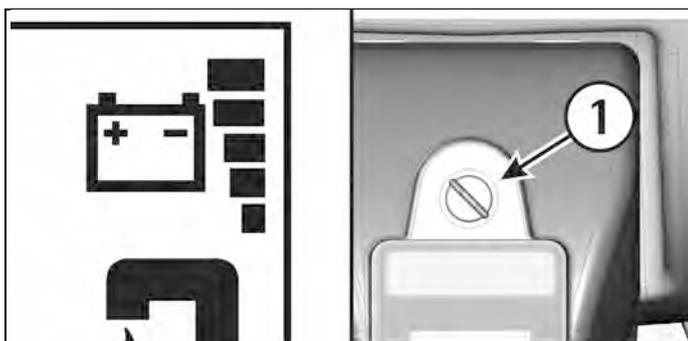
3. Verificare che il connettore batterie sia inserito correttamente.
