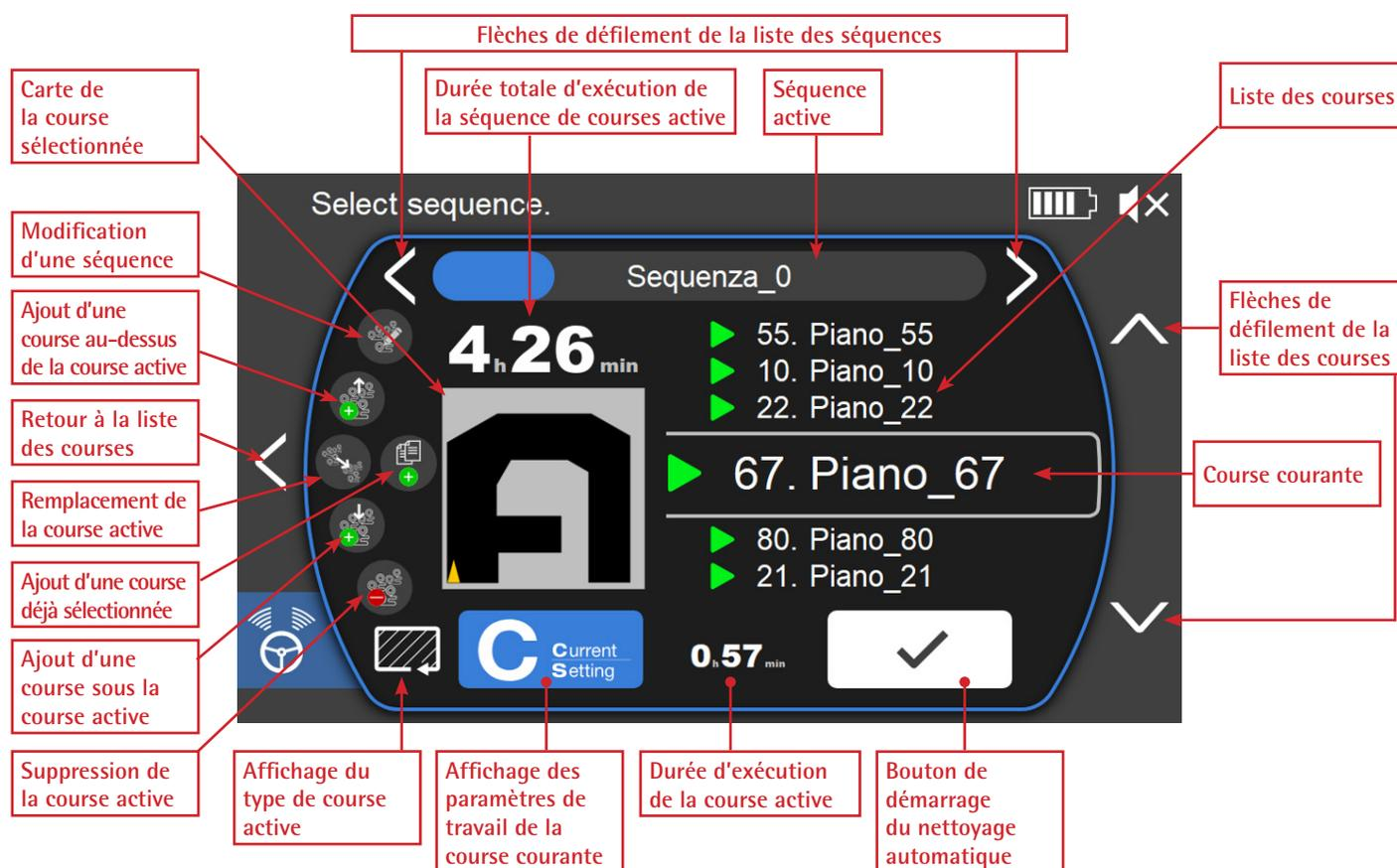
Les « flèches de défilement de la liste des séquences » permettent de faire défiler les séquences en mémoire. La barre bleue indique la position actuelle de la séquence sélectionnée dans la liste des séquences en mémoire.
