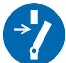
Pictogramme indiquant l'obligation de déconnecter le système des batteries à l'aide du connecteur avant toute intervention sur la machine.
