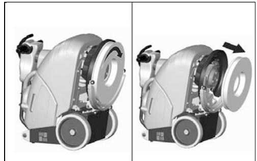
3. Pour remettre la brosse, enclencher les boutons présents dans leurs sièges du plateau porte-brosse et tourner dans le sens inverse aux aiguilles d'une montre pour obtenir le blocage.
