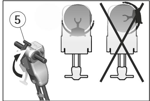
Il est possible soulever le suceur quand il se trouve à proximité du point central. Si le suceur ne se trouve pas à proximité du point central, même si en mouvant le levier (5), il ne se soulèvera pas.
