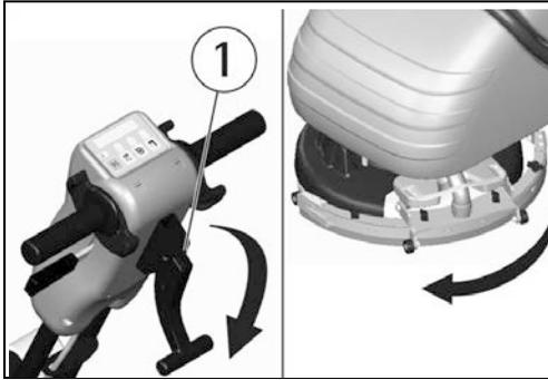
3. Avec le suceur dans cette position procéder à le démonter et ensuite la bavette arrière du suceur (voir dans "REPLACEMENT DE LA BAVETTE ARRIERE DU SUCEUR").
