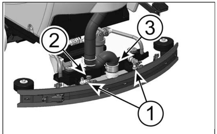
3. Décrocher la fermeture (1) de la lame presse-bavette, dégager les extrémités (2) du corps de suceur et enlever la bavette (4).
