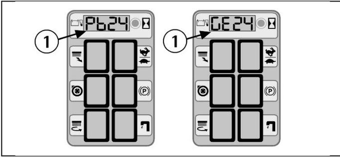
L'indicateur de niveau de charge des batteries (1) est digital et indique le pourcentage de charge des batteries. 100 est la charge maximale, jusqu'à un minimum de 10 en indiquant chaque diminution de 10%.
