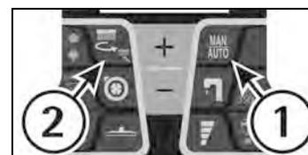
Sur le display deviendra clignotant la valeur de P1, P2 ou P3. Appuyer sur les boutons (+) et (-) pour sélectionner la pression, à la fin des éclairs la valeur est réglée.
