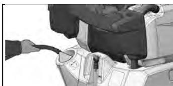
4. Rincer avec un jet d'eau le réservoir de la solution.
