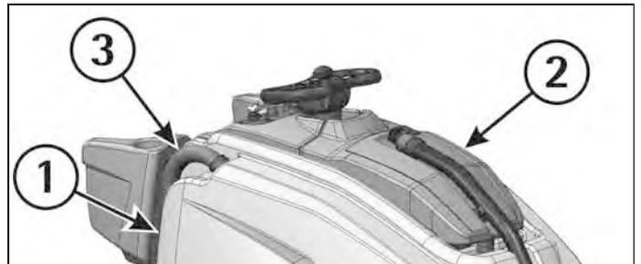
Grâce au système du blocage à 2 niveaux, la machine permet la recharge des batteries avec une ouverture partielle du réservoir.
