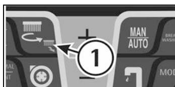
En el display comienza a parpadear el valor de P1, P2 o P3. Apretar las teclas (+) y (-) para seleccionar la presión, al final de parpadear el valor está fijado.
