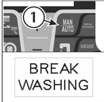
De esta manera automáticamente se levantan los cepillos, la electroválvula se cierra y se puede así terminar el trabajo de secado por un tiempo total de 15 segundos, desde entonces se levanta también la boquilla de secado y se apaga la aspiración.
